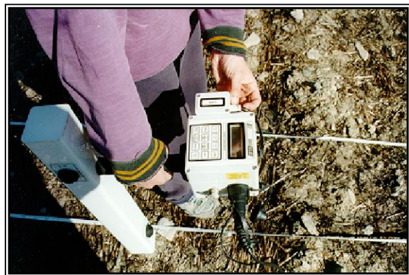
EΙΚΟΝΑ 2.1.: Το όργανο Geoscan Research FM36 που χρησιμοποιήθηκε κατά τις μαγνητικές διασκοπήσεις.
