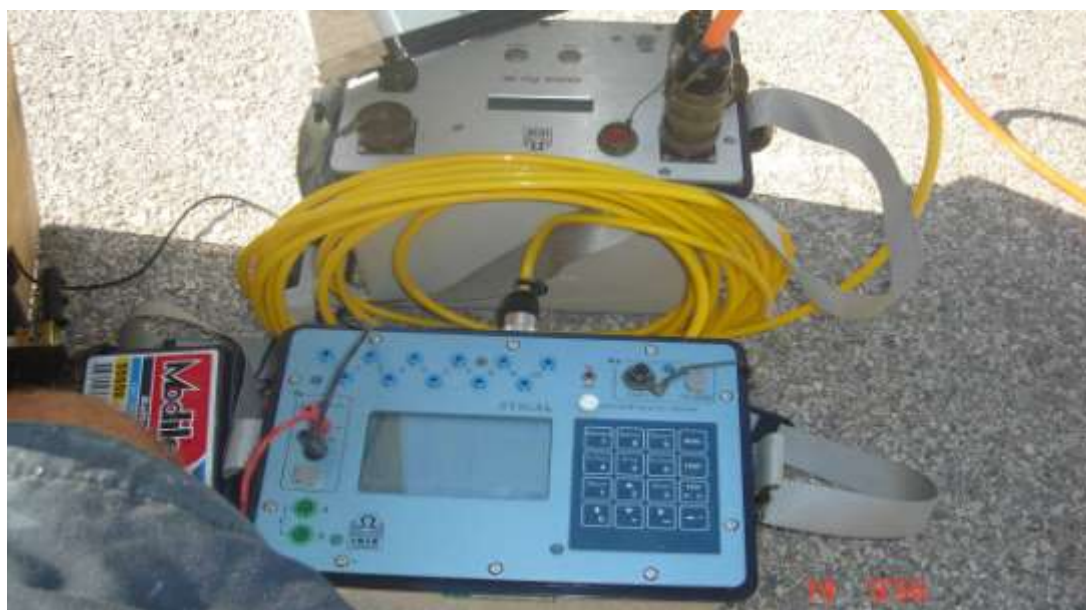
Εικόνα 3.4: Φωτογραφία του οργάνου SYSCAL Pro (κάτω τμήμα εικόνας) και του πολυπλέκτη SYSCAL Switch Pro (πάνω τμήμα εικόνας).
