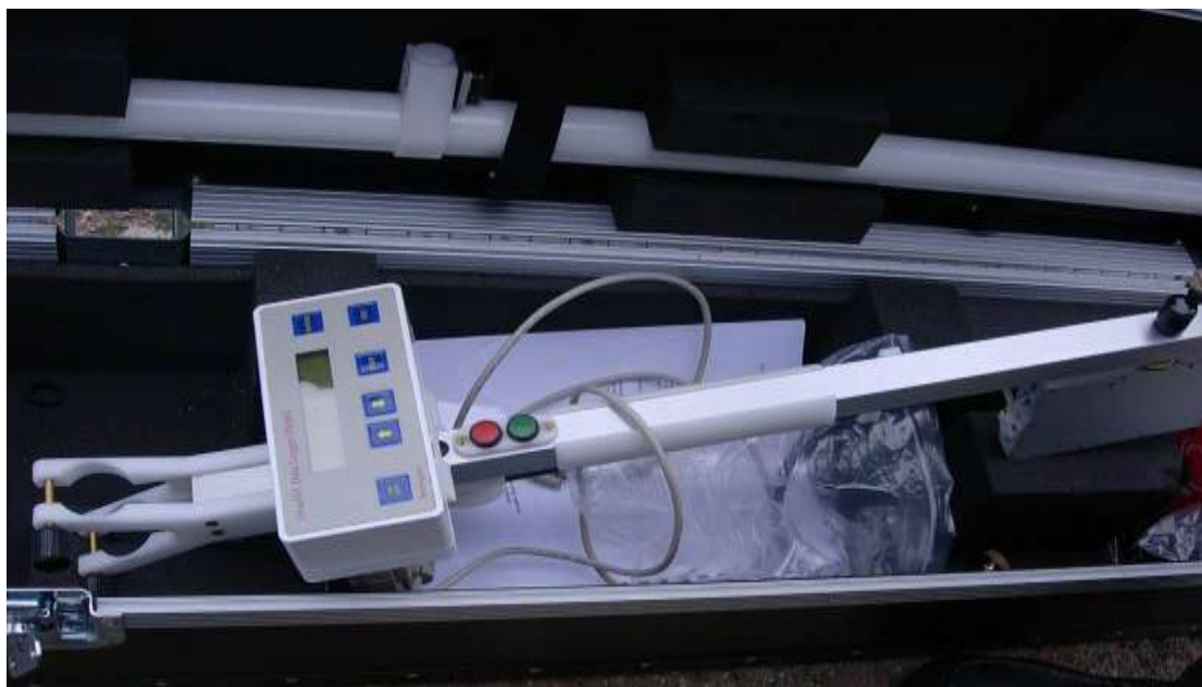
Εικόνα 3.6. Το διαφορικό μαγνητόμετρο ροής Bartington Instruments Grad601.
