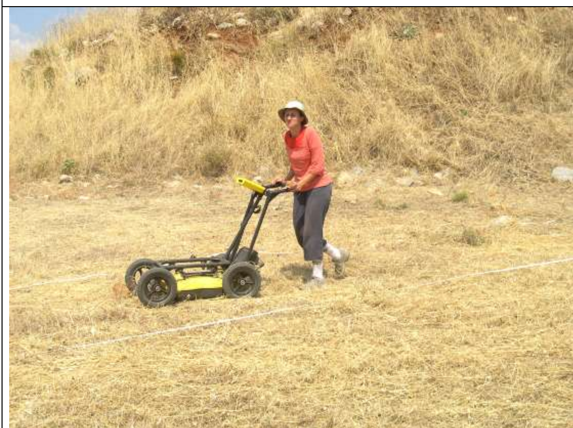
Εικόνα 1.7. Λεπτομέρειες από την διεξαγωγή των γεωφυσικών μετρήσεων με τις μαγνητικές τεχνικές και το γεωραντάρ στην περιοχή της Μαγούλας Ζερέλια.
